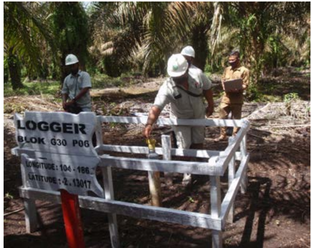
Checking water level in peatland using a data logger Memeriksa tinggi level air di lahan gambut menggunakan data logger
